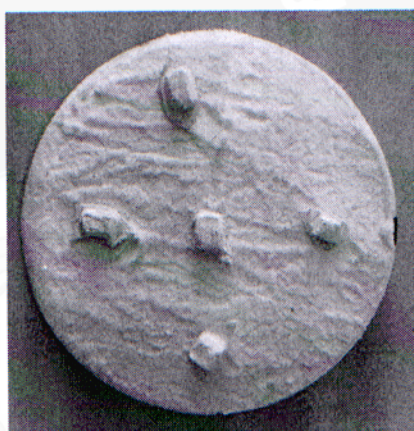
รูป 11 ลักษณะการเชื่อมต่อแก้วกับแผ่นอิเล็กโทรไลต์
