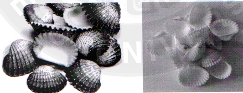
ภาพที่ 38 ลักษณะเปลือกหอยแครงก่อนและหลังแช่ด้วยสารละลายไฮโดรเจนเปอร์ออกไซด์เข้มข้น ร้อยละ 30 โดยน้ำหนัก
