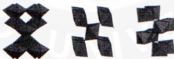
รูปที่ 3 โครงสร้างของไททาเนียมไดออกไซด์ (ก) อนาเทส (ข) แบบรูไทล์ และ (ค) แบบบรูคไท์
