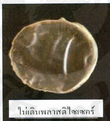
ภาพที่ 26 ลักษณะทางกายภาพของฟิล์มเซลลูโลสดัดแปรที่ไม่เติมพลาสติกไซเซอร์
