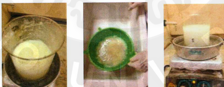
ภาพที่ 17 การย่อยเยื่อเปลือกข้าวโพดด้วยสารละลายกรดไฮโดรคลอริก
