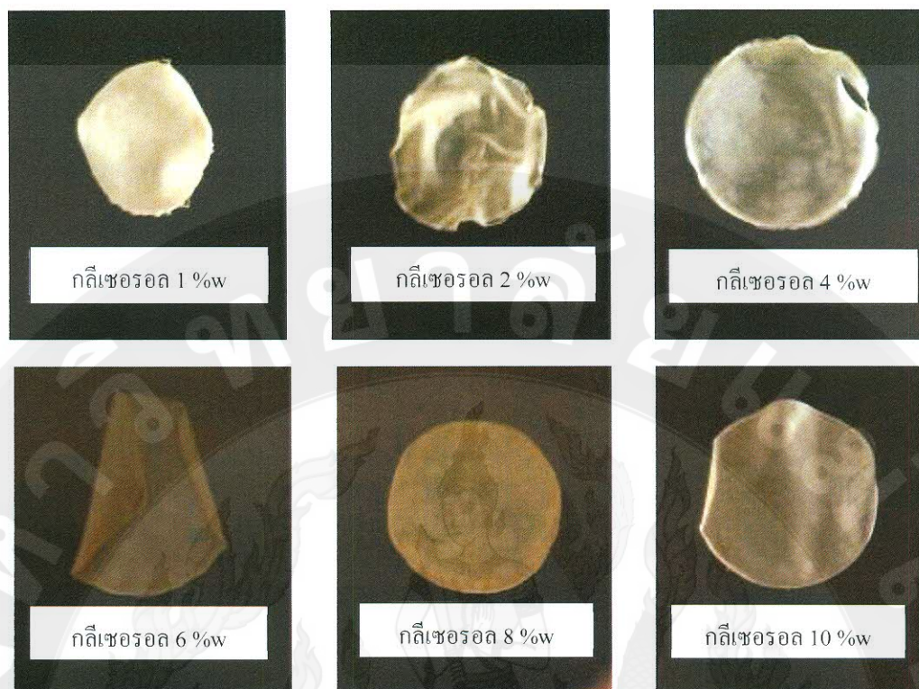
ภาพที่ 27 ลักษณะทางกายภาพของฟิล์มเซลลูโลสตัดแปรที่ใช้กลีเซอรอลเป็นพลาสติกไซเซอร์
