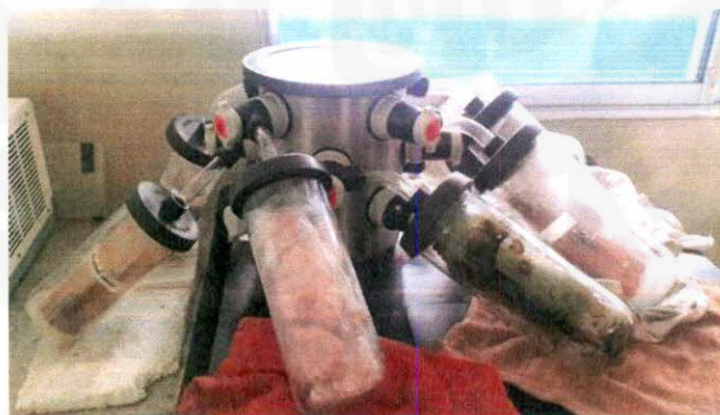
ภาพที่ 11 การย่อยเยื่อเปลือกข้าวโพดด้วยสารละลายกรดไฮโดรคลอริก
