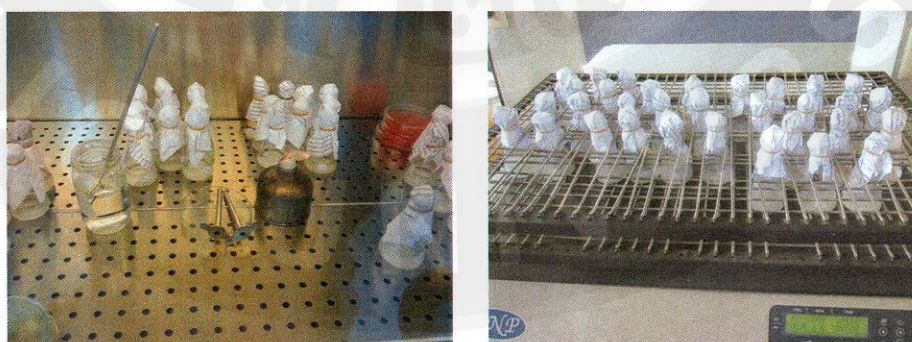
ภาพ 15 วิธีการทดสอบในอาหารเหลว การเขี่ยเชื้อลงในขวดอาหารปลอดเชื้อ (ในตู้ปลอดเชื้อ) และเขย่า 200 รอบต่อนาที เป็นเวลา 3, 5 และ 7 วัน
