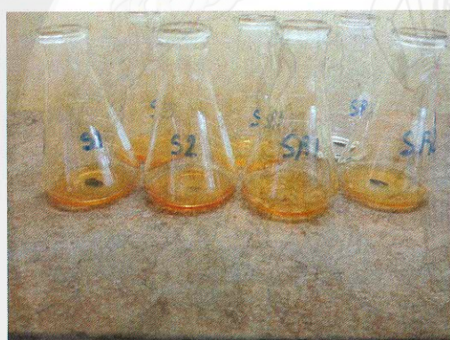
ภาพ 21 แสดงวิธีการหาฟอสฟอรัสทั้งหมดในดินโดยวิธีการย่อยในกรด \text{HNO}_3 : \text{HClO}_4 (6:1)
