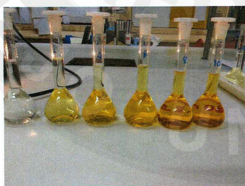
ภาพ 22 การทำกราฟมาตรฐานสำหรับการคำนวณฟอสฟอรัสทั้งหมดในดิน ด้วยเครื่อง Spectrophotometer
