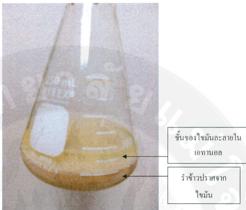
ภาพผนวก 1 การสกัดไขมันออกจากรำข้าวด้วยการเขย่ากับเอทานอล
