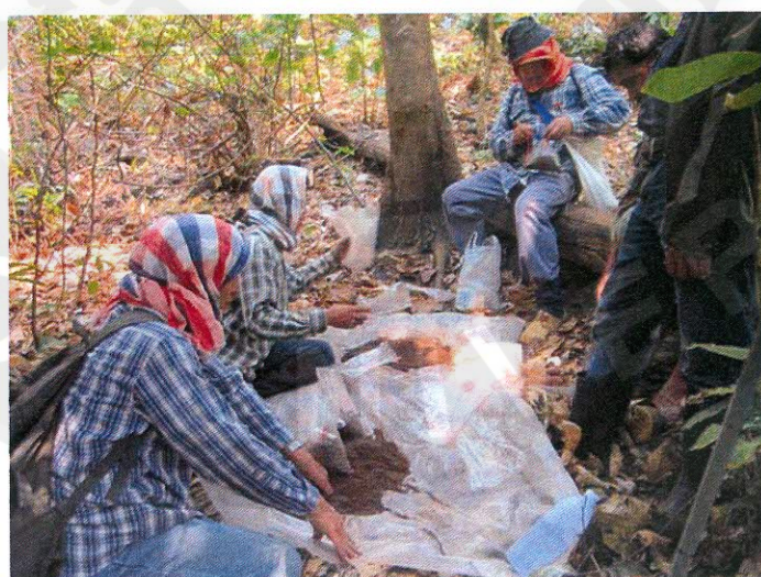
ภาพที่ 6 การเก็บตัวอย่างดินในแปลงเพื่อนำไปวิเคราะห์ในห้องปฏิบัติการ
