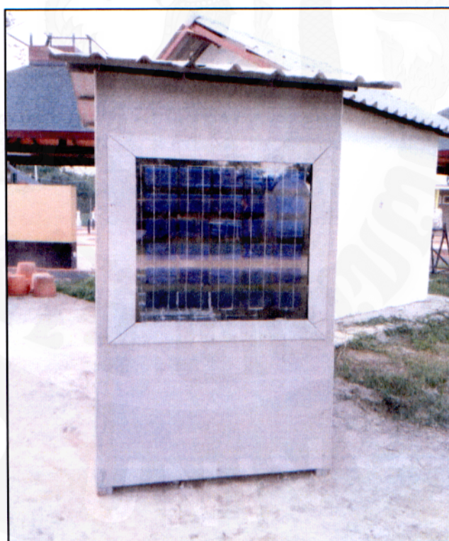
ภาพที่ 55 อาคารแบบจำลองที่ติดตั้งแผงเซลล์แสงอาทิตย์ในการทดสอบ
