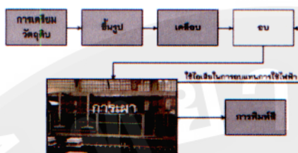
รูปที่ 3 การนำความร้อนที่กลับคืนของห้องอบแห้งโรงงานเซรามิก
