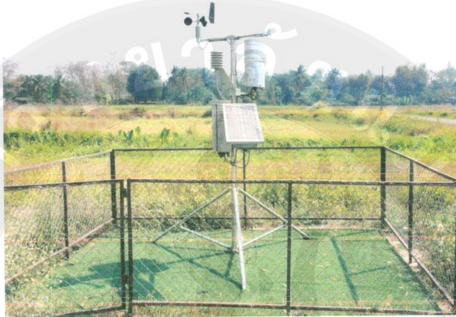
ภาพที่ 6 สถานีตรวจวัดอากาศ ศูนย์วิจัยพืชไร่เชียงใหม่ ต.หนองหาร อ.สันทราย จ.เชียงใหม่ ประกอบด้วยอุปกรณ์วัดอุณหภูมิการแผ่รังสีเฉลี่ย(Mean radiant temperature) อุปกรณ์วัดอุณหภูมิ(Air temperature) อุปกรณ์วัดความชื้นสัมพัทธ์(Relative humidity) อุปกรณ์ตรวจวัดทิศทางและความเร็วลม (Wind Speed and Direction)
