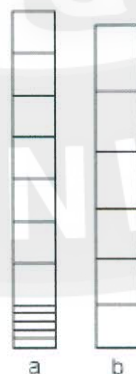
ภาพที่ 42 แสดงรูปแบบกริดเซลล์ในแนวตั้ง a) กริดเซลล์ telescoping b) เซลล์ขนาดคงที่ ที่มา : Huttner S. (2012)
