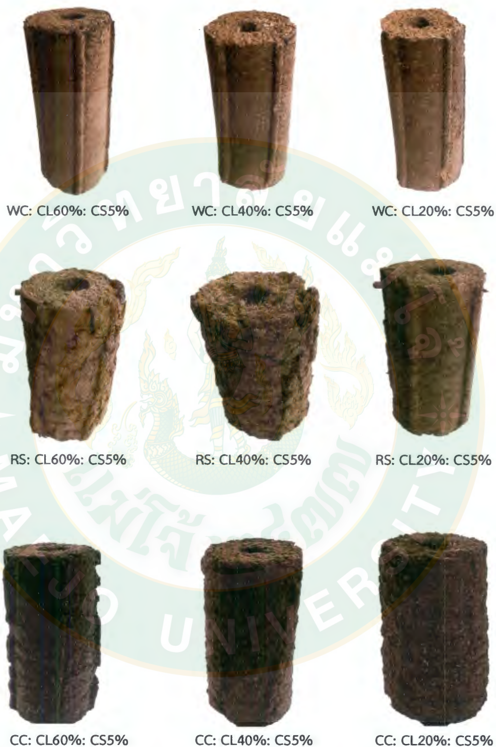
ภาพผนวกที่ 5 ลักษณะทางกายภาพของเชื้อเพลิงอัดแท่งทางมะพร้าวเป็นตัวประสาน ร่วมกับแป้งมันสำปะหลัง 5%
