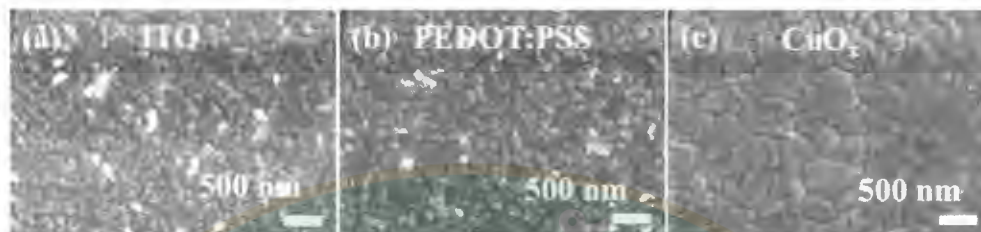
รูปที่ 25 ลักษณะผิวของชั้นเพอรอฟสไกต์บนชั้นวัสดุนำโฮลต่างชนิดกัน (Zhi-Kai, Wei-Fei et al. 2017)
