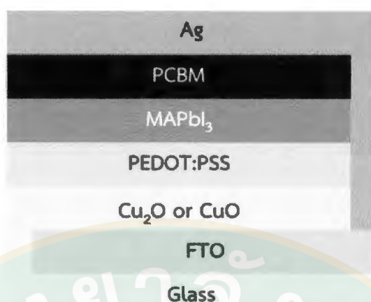
รูปที่ 59 โครงสร้างของเซลล์แสงอาทิตย์เพอรอฟสไกต์เมื่อผ่านขั้นตอนการทำขั้วโลหะ
