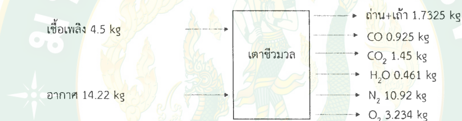
ภาพที่ 82 การสมดุลมวลของระบบเตาชีวมวลของการใช้เชื้อเพลิงฟางข้าว
