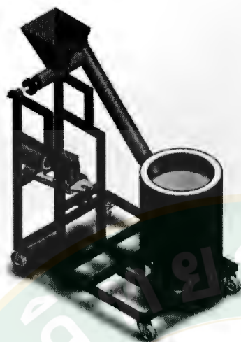
ภาพที่ 54 ระบบป้อนเชื้อเพลิงอย่างต่อเนื่องด้วยสกรูลำเลียงของเตาชีวมวล
