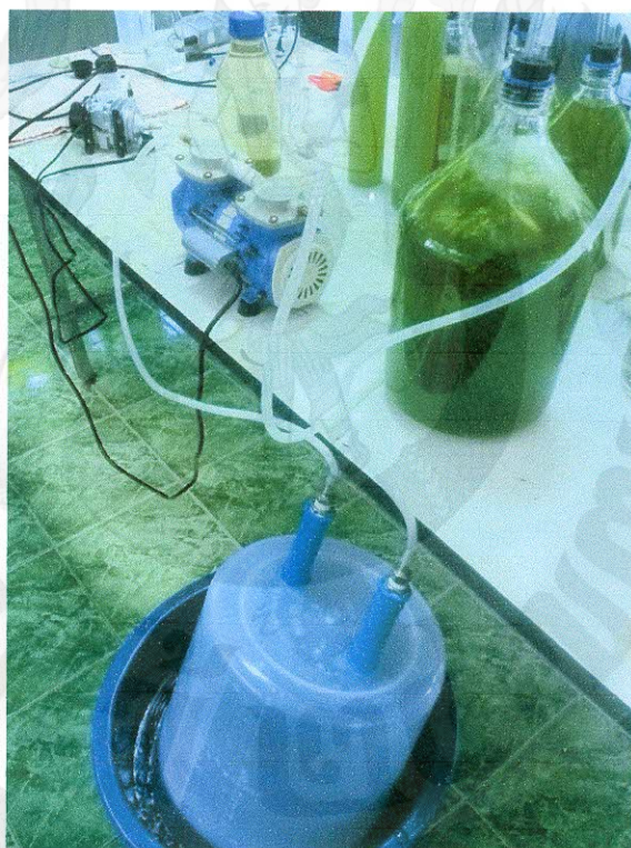
ภาพที่ 33 การทดสอบประเมินระบบการปรับปรุงคุณภาพก๊าซชีวภาพโดยใช้สาหร่าย Chlorella sp.
