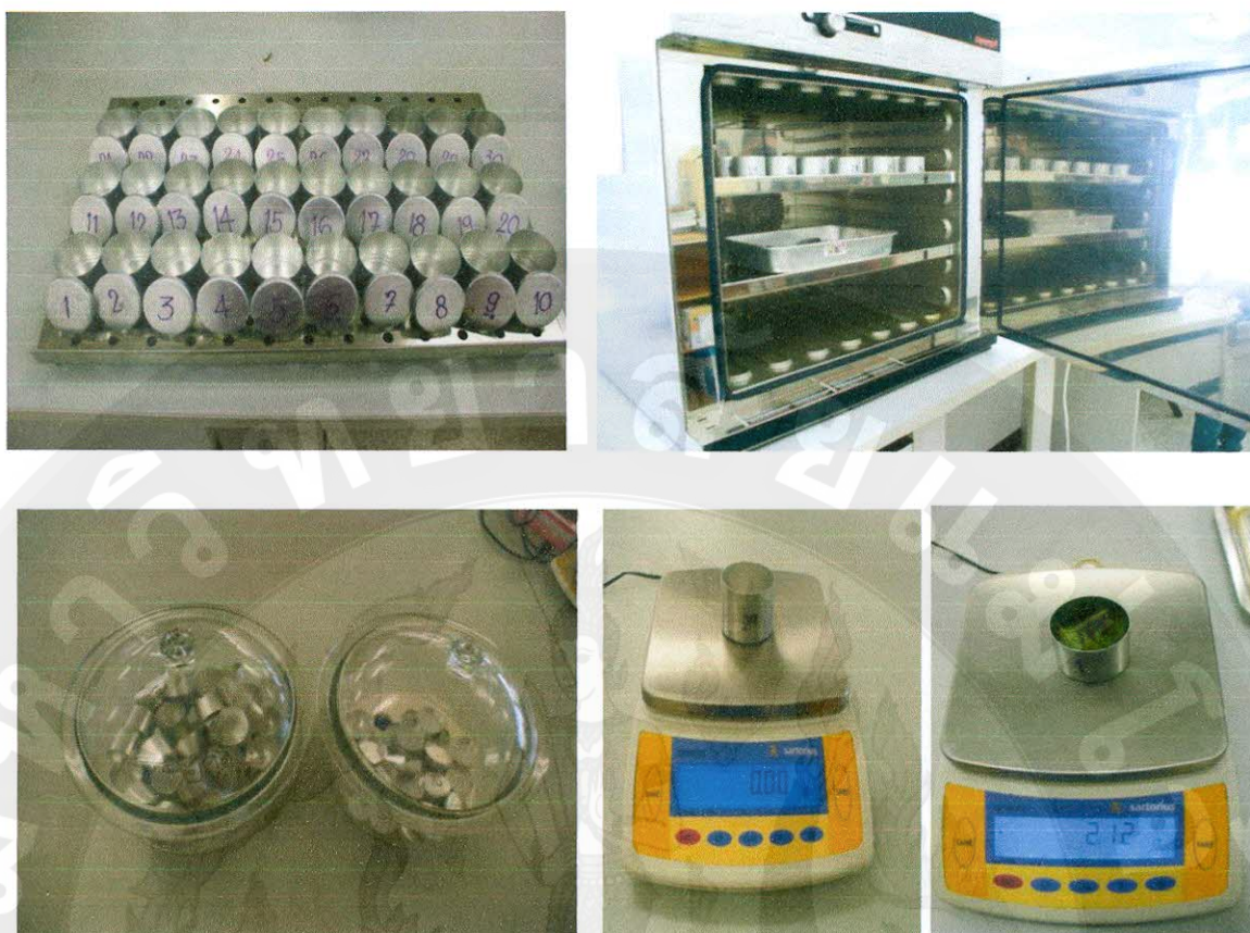
รูปที่ 4.2 ขั้นตอนการเตรียมอุปกรณ์ ตัวอย่าง เพื่อหาค่าความชื้นเริ่มต้น ตามวิธีมาตรฐาน AOAC (2010)
