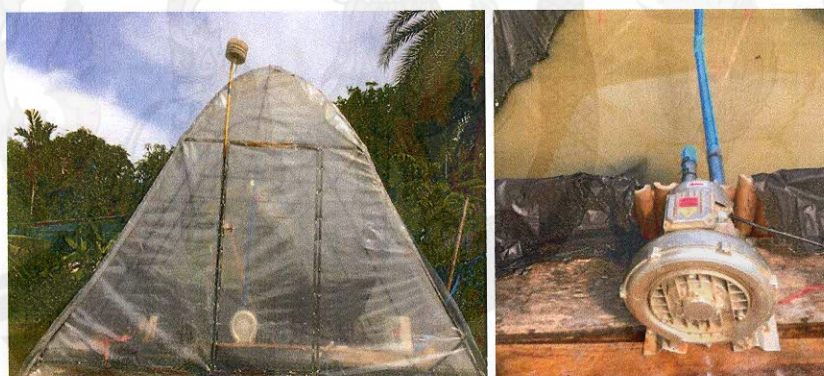
ภาพที่ 22 ลักษณะการติดตั้งปั๊มเติมอากาศร่อนสำหรับเติมอากาศร่อนลงกระชังเลี้ยงปลา
