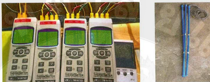
ภาพที่ 18 เทอร์โมมิเตอร์ (Lega รุ่น TM-947SD, สายเทอร์โมคัปเปิล ชนิด K)
